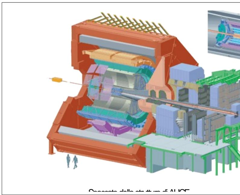
Partendo dal volume a ridosso della zona d'interazione e muovendosi radialmente verso l'esterno, vi sono: il rivelatore di vertice ITS, costituito da 6 strati cilindrici di rivelatori rispettivamente a pixel di silicio, a deriva di silicio e a microstrip di silicio; una camera di tracciamento a gas (TPC); rivelatori per elettroni, positroni ed altre particelle ad alto impulso (TRD, HMPID); un rivelatore di tempo di volo (TOF); uno spettrometro per
