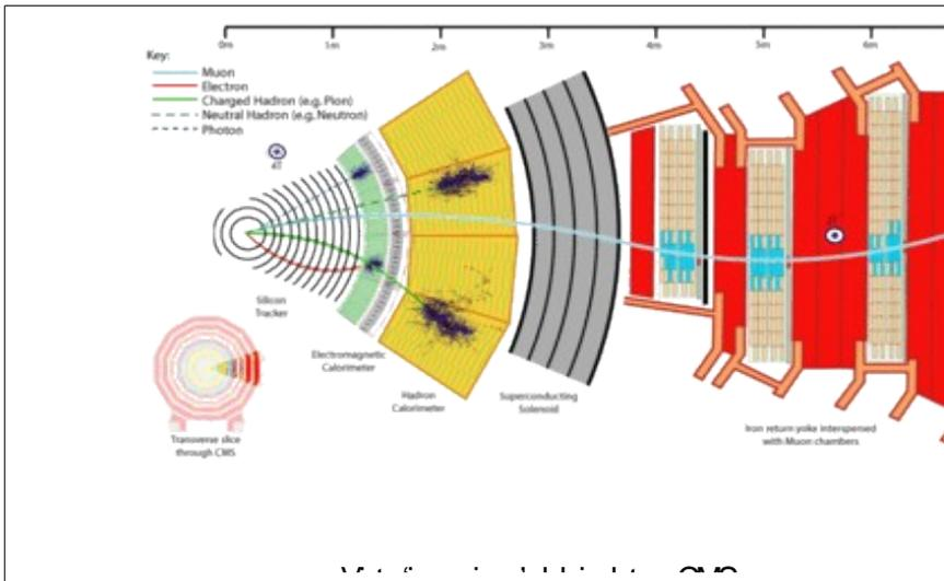
CMS è stato quindi progettato per essere un rivelatore "general-purpose", in grado di studiare molti aspetti delle collisioni dei protoni a 14 TeV. È costituito da una struttura cilindrica del peso di 12500 tonnellate lunga 21 metri e con diametro di 16 metri, in fase di assemblaggio all'interno di una cavità sotterranea nei pressi di Cessy, in Francia. È strutturato in sotto-rivelatori che permettono la misura di
