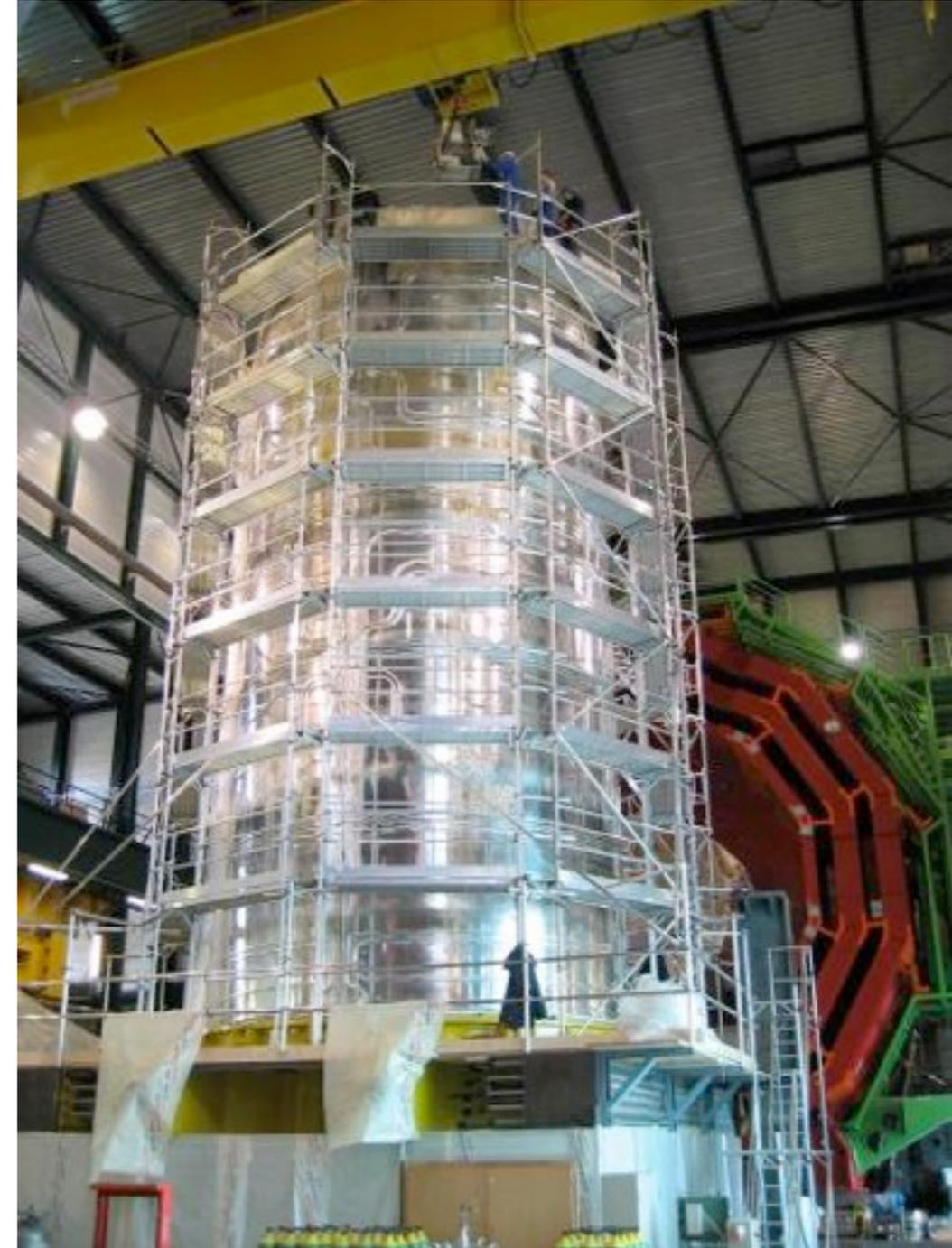
**Magnete:** una corrente di 20.000A attraverso superconduttore di niobio-titanium a  $-270^{\circ}\text{C}$  produce un campo magnetico di 3.8T. Permette di incurvare le tracce cariche e di misurarne il momento.
