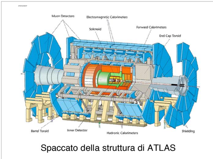
Le particelle prodotte nell' urto fra i protoni del fascio sono emesse in tutte le direzioni. L' apparato che le rileva ha quindi la forma di un cilindro intorno all' asse del fascio. Come mostrato nella figura sotto, il rivelatore ATLAS e' formato da più sotto-rivelatori: il calorimetro elettromagnetico misura l' energia degli elettroni e dei gamma prodotti e permette la loro identificazione. Il calorimetro
