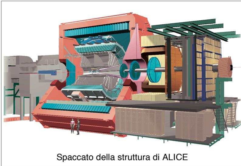
verso l'esterno, vi sono: il rivelatore di vertice ITS, costituito da 6 strati cilindrici di rivelatori rispettivamente a pixel di silicio, a deriva di silicio e a microstrip di silicio; una camera di tracciamento a gas (TPC); rivelatori per elettroni, positroni ed altre particelle ad alto impulso (TRD, HMPID); un rivelatore di tempo di volo (TOF); uno spettrometro per fotoni (PHOS); un calorimetro
